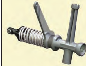
A. Ajuste/afloje la tapa superior
