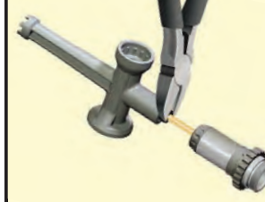
C. Extraiga/instale el cabezal de rótula
